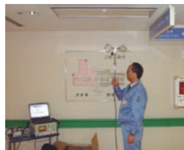
病棟での電波測定実験
